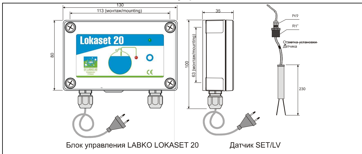
Рис. 5. Сигнализация для емкости Loka: LOKASET 20 –блок управления и SET/LV-датчик.
